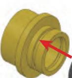
品番⑬ブッシュガスケット(Oリング)をシリンダガスケットと同じ要領で組み付けて下さい。
