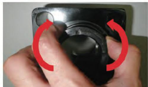
品番⑫シリンダガスケット(ローリング)を絞るように押し出し、溝から取り外してください。(上写真参照)
