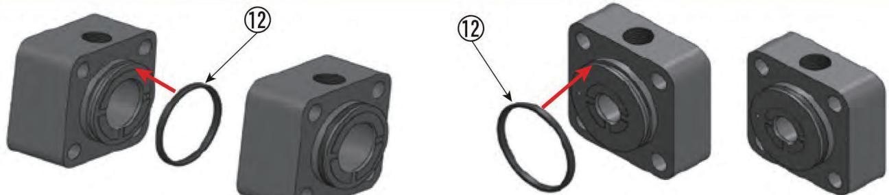
品番⑫シリンダガスケット(Oリング)は、Oリング装着溝に一部分を引っ掛け、Oリングを伸ばしながら、溝に装着して下さい。装着されたOリングが捻じれていなかを確認して下さい。
